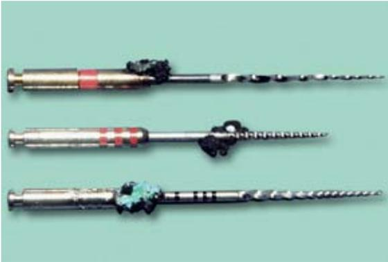
**Abb. 2** Makroskopisch deutlich sichtbar sind die Auflagerungen auf den Feilen nach einem Korrosionsprozess. Die Auflagerungen sind der sichtbare Nachweis einer kathodischen Teilreaktion.
