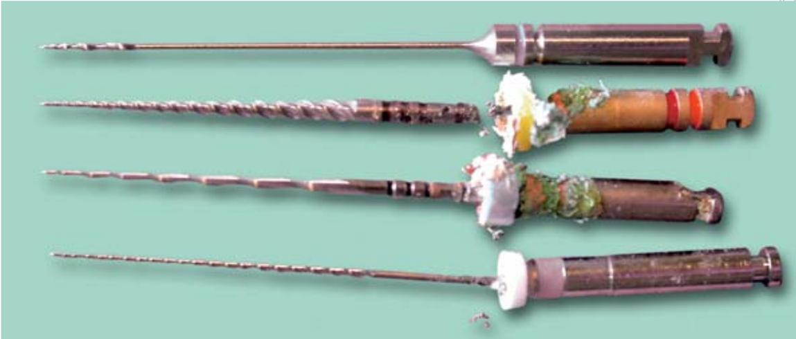
**Abb. 7** Von vier Instrumenten unterschiedlicher Hersteller zeigen drei Instrumente massive Korrosionsschäden nach Lagerung in einer NaOCl-Lösung. Die makroskopisch sichtbare Korrosion lief jeweils ausschließlich unterhalb des Schaftes im Bereich von Lot und Gummistopper ab. Die Ursache ist hier sehr wahrscheinlich eine Spaltkorrosion.
