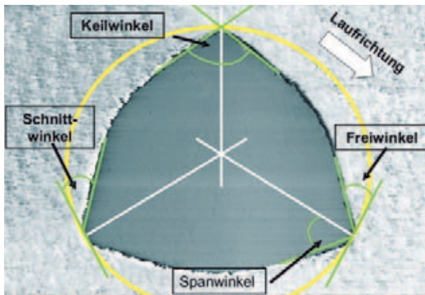
Abb. 7 FlexMaster®-Feile (aus Abb. 3) im Querschnitt bei 149facher Vergrößerung. Die Außenkontur des Instruments zeigt deutlich konvexe Flächen. Die Werte der angegebenen Winkel sind Tabelle 1 zu entnehmen
